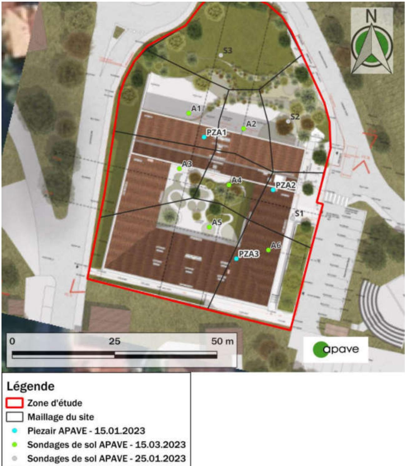
Figure 6 : Localisation des investigations de sol réalisées sur site (plan de masse projet client) (source : APAVE, mars 2023)
