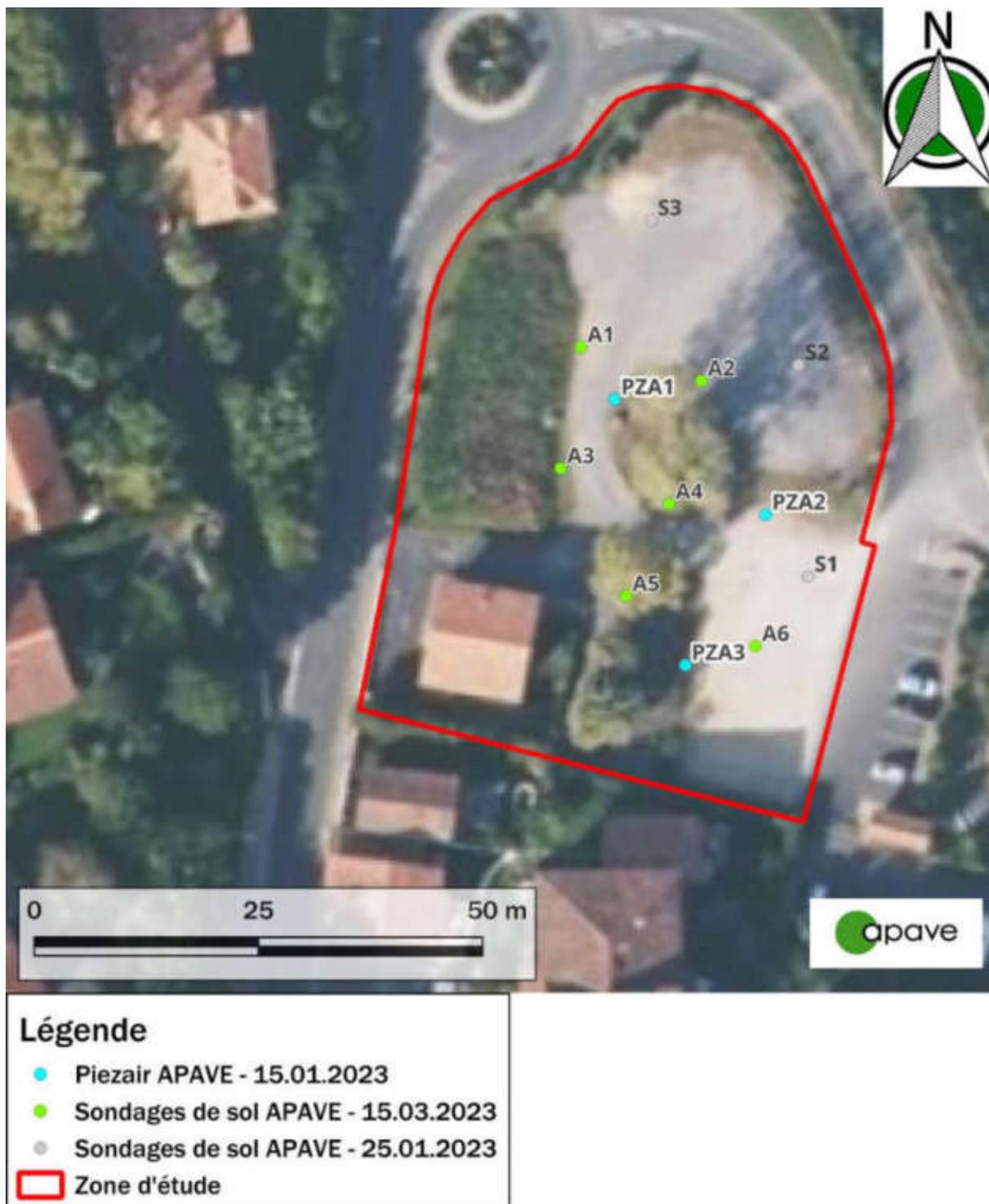
Figure 12 : Localisation des piézairs mis en œuvre sur fond de photographie aérienne (source : APAVE, mars 2023)
